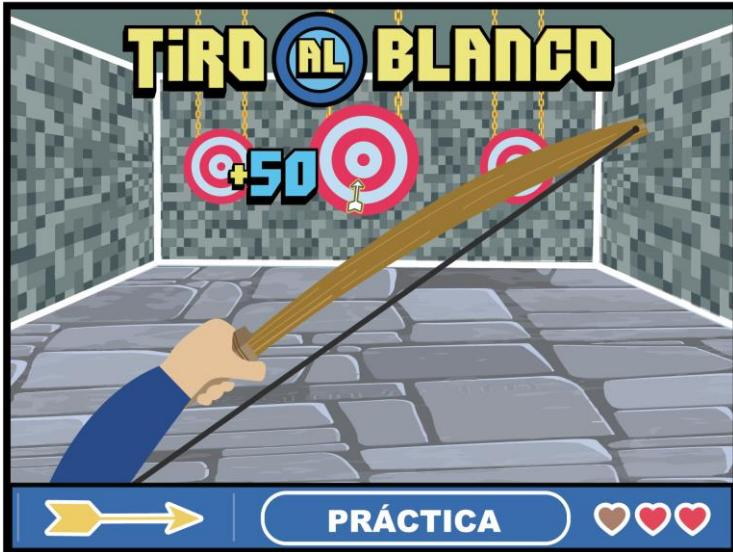
Para programar videojuegos de este tipo, se utiliza por lo general, la herramienta **Raycast**, que mediante el trazado de un rayo detecta si la flecha lanzada impactará con otros objetos.
